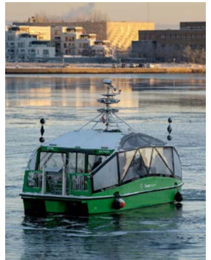
Den førerløse elfærge "Greenhopper" i testrute på tværs af Limfjorden © DTU / Martin Dam Kristensen
